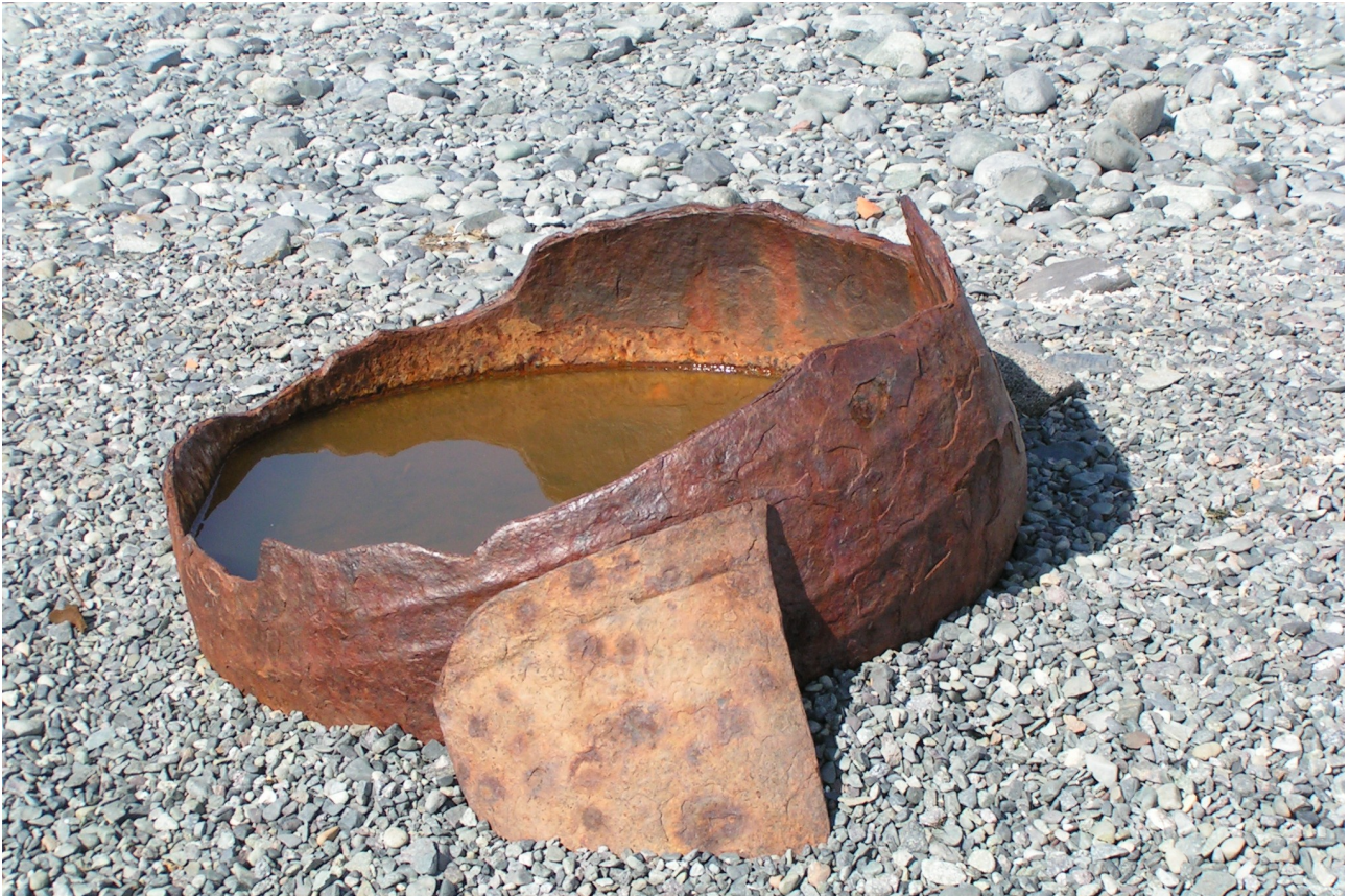
Ein Trypot ist ein großer gusseiserner Kessel zum Auskochen von Robben- oder Walöl.
